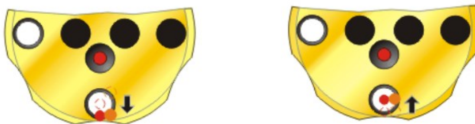
Slika 5.8 Vertikalno podešavanje snopa [2]
