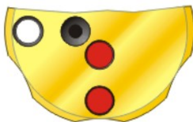
Slika 5.10 Laserski zatvarač zakrenut u položaj za mjerenje [2]
