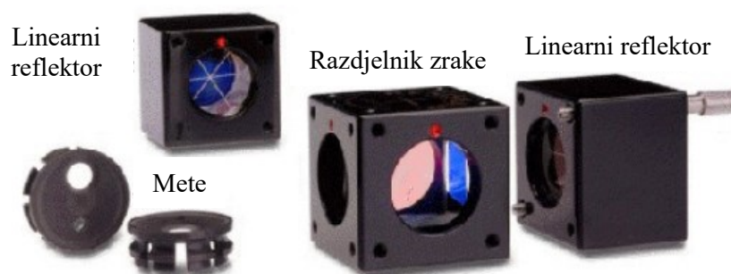
Slika 4.5 Linearna mjerna optika [2]
