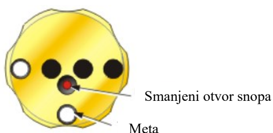
Slika 5.1 Laserski zatvarač sa zrakom smanjenog promjera [2]
