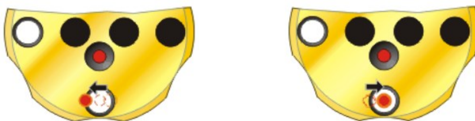
Slika 5.9 Horizontalno podešavanje snopa [2]
