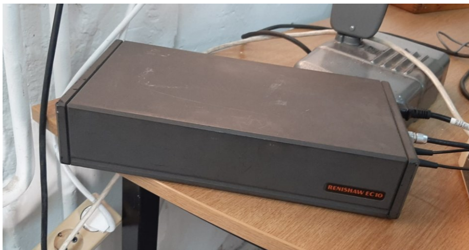
Slika 4.2 Jedinica za kompenzaciju okoline EC10
