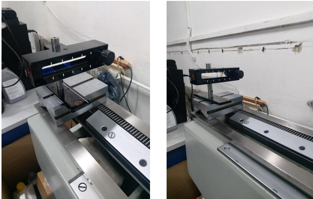
Slika 47. Reflektor pravocrtnosti – horizontalno ispitivanje
