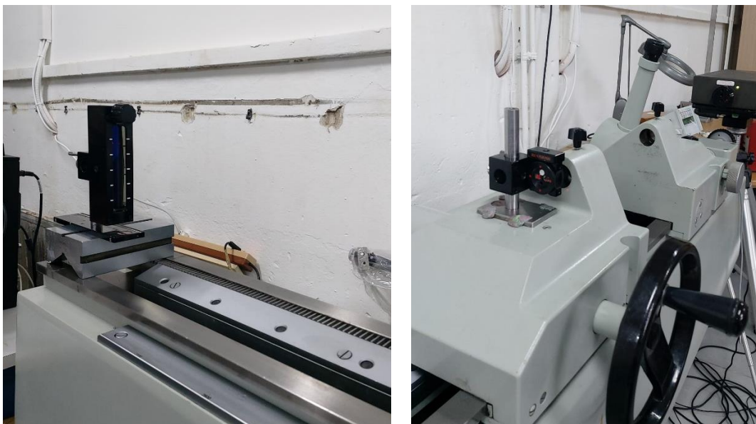
Slika 50. Reflektor pravocrtnosti i interferometar – vertikalno ispitivanje pravocrtnosti vođenja
