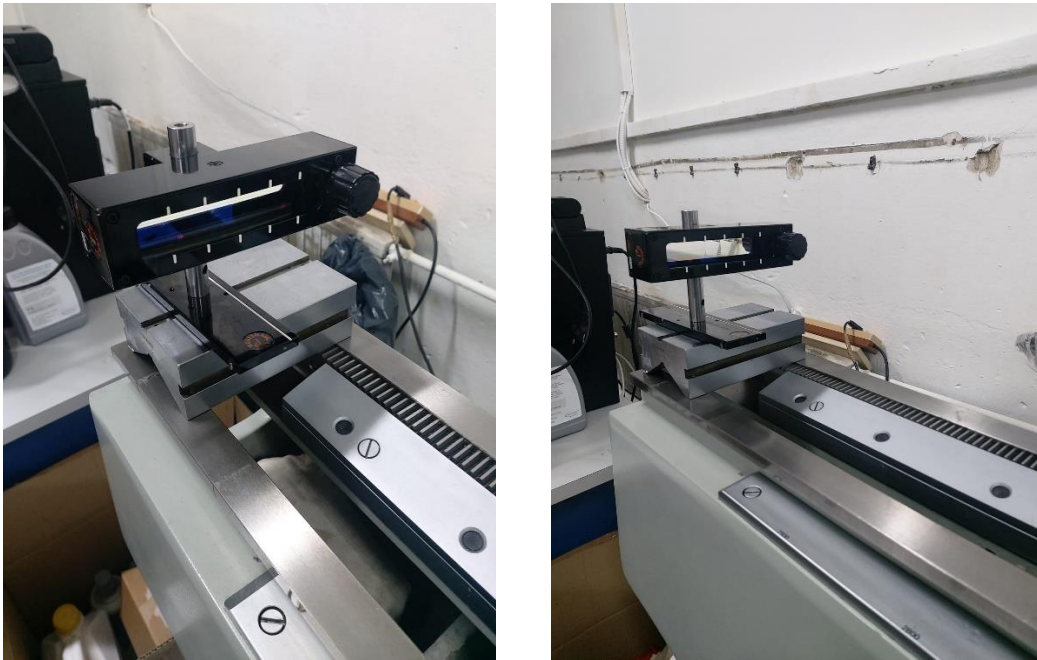
Slika 47. Reflektor pravocrtnosti – horizontalno ispitivanje
