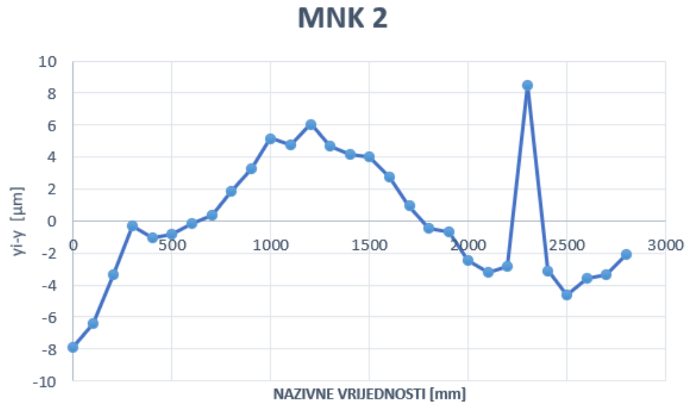
Slika 60. Odstupanje drugog mjerenja od horizontalne pravocrtnosti
