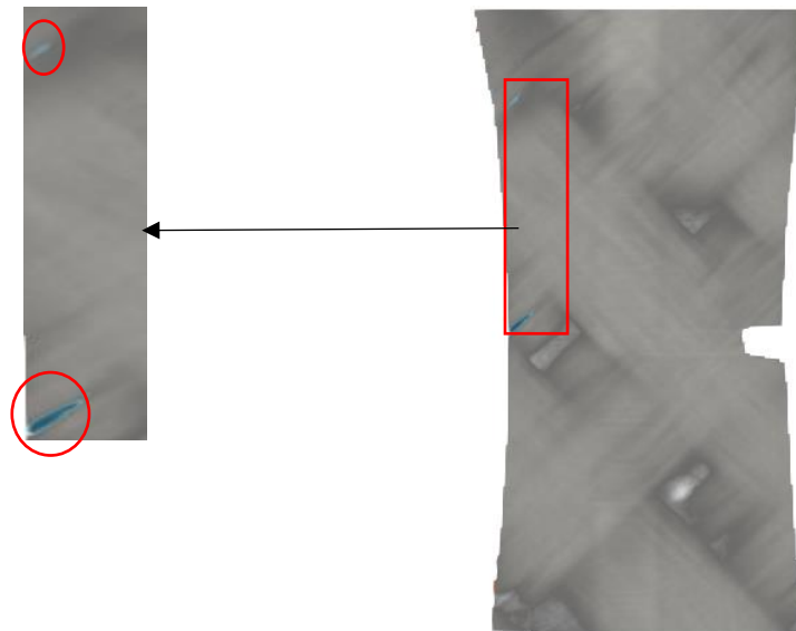
Slika 31. Preklop krišaka korigiranog deformiranog volumena i pripadajućeg polja reziduala
