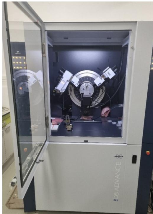
Slika 22. Difraktometar Bruker D8 Advance
