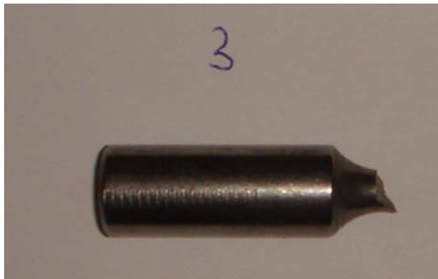
Slika 4.8 Epruveta iz treće grupe nakon loma
