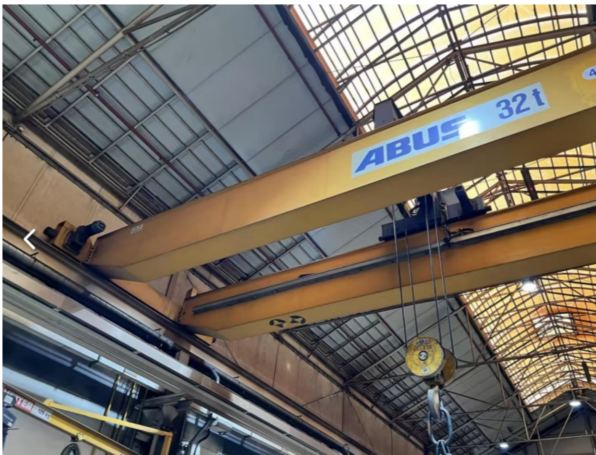
Slika 13. Mosni granik s dva glavna nosača kutijastog profila
