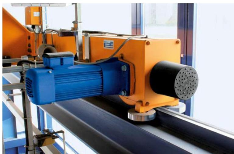
Slika 2. Abus crane systems – mehanizam potisnog valjak
