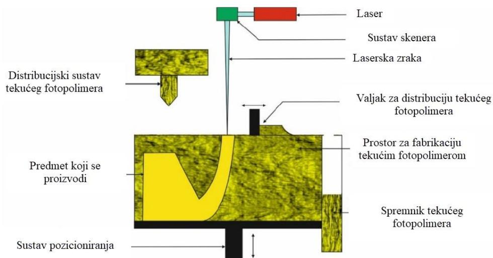
Slika 3.2 Stereolitografija [8]
