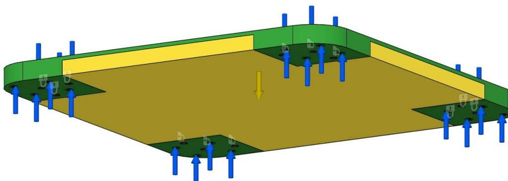
**Slika 4.6 Priprema generativnog dizajna tijela robota**
