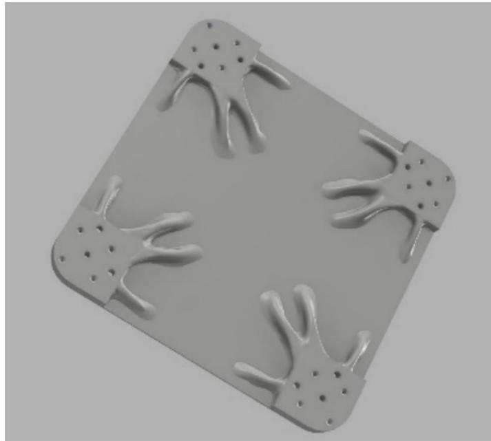
**Slika 4.7** Rezultat generativnog dizajna tijela robota
