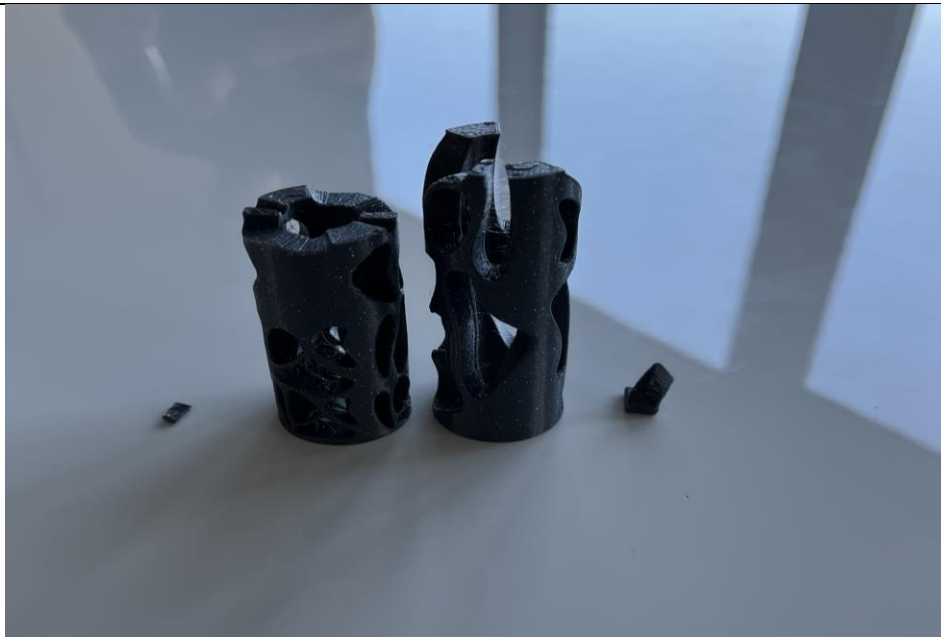
Slika 32. Prikaz puknuća strukture modela M1
