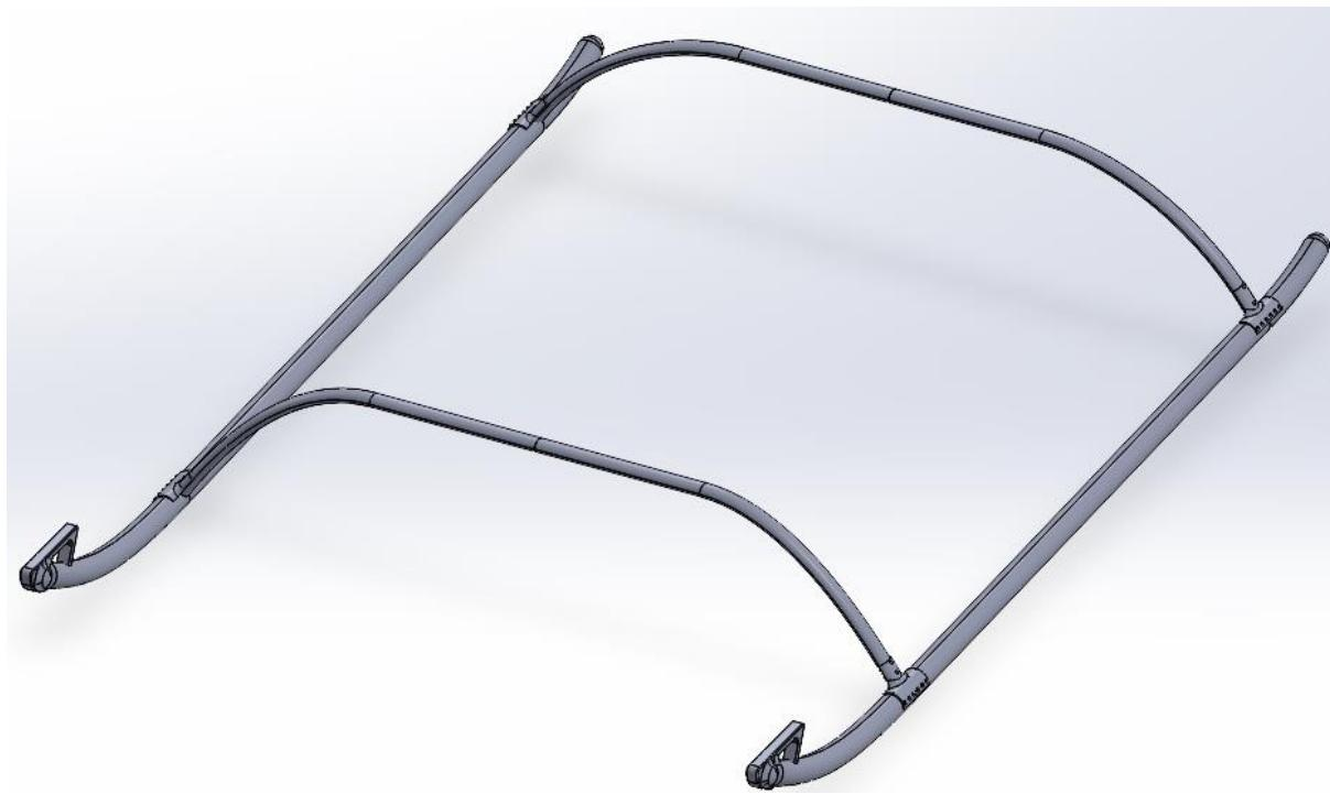
**Slika 31. CAD model podvozja helikoptera**
