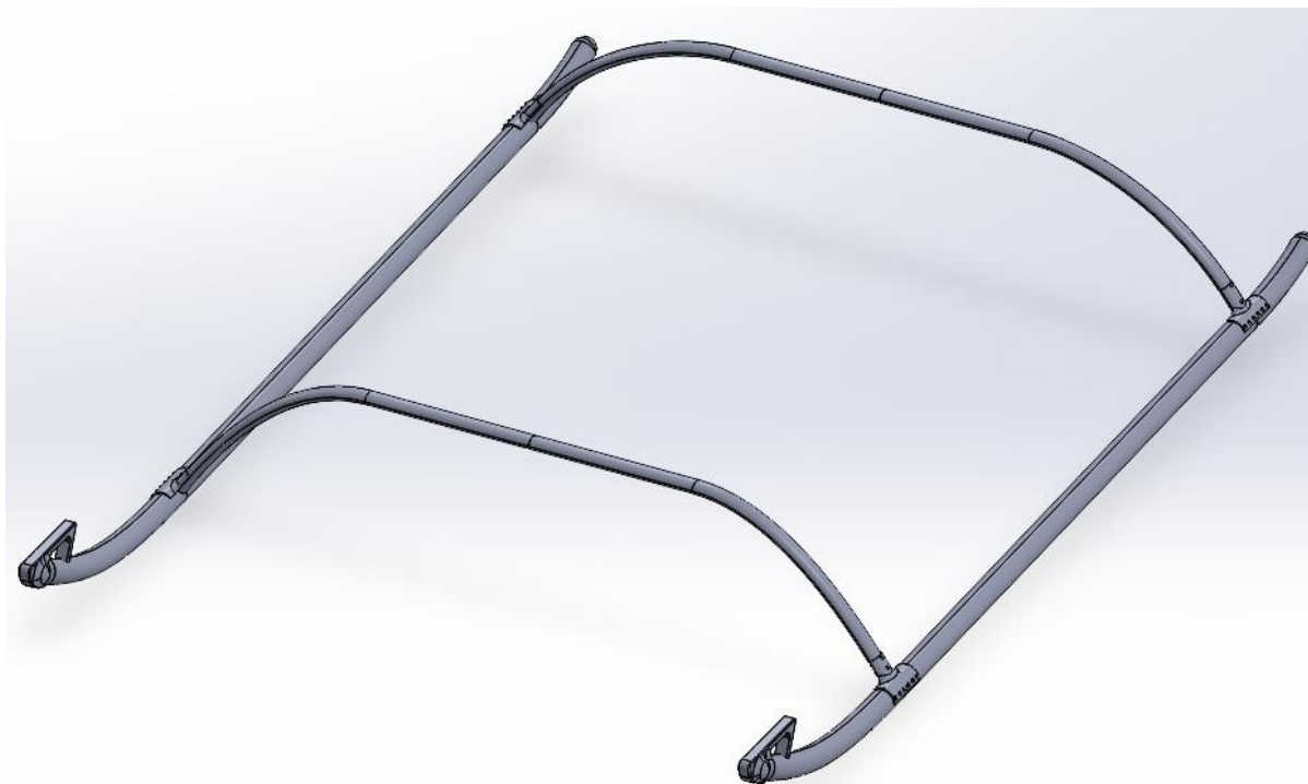
Slika 31. CAD model podvozja helikoptera
