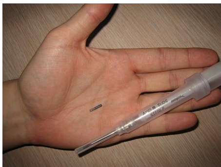
Slika 2.8. RFID mini čip [9]
