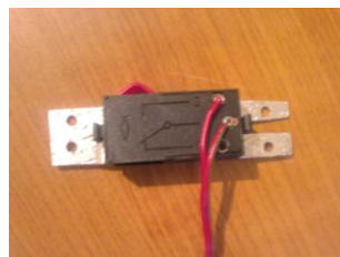
Slika 5.1. Fotografija tipkala sa nosačem
