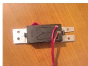
**Slika 5.1.** Fotografija tipkala sa nosačem
