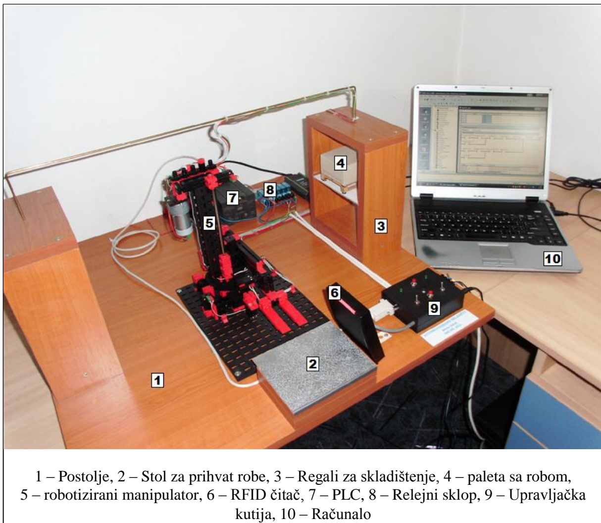
Slika 5.6. Fotografija eksperimentalnog modela automatiziranog sustava skladištenja
