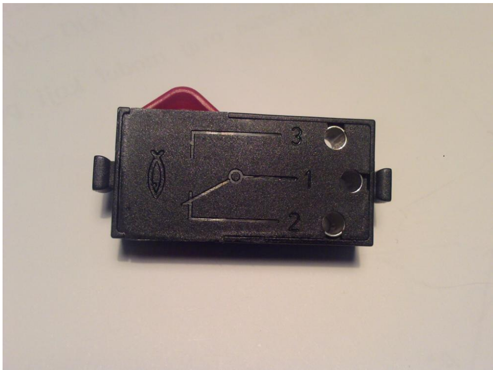
Slika 4.3. Fotografija tipkala „Fischertechnik“
