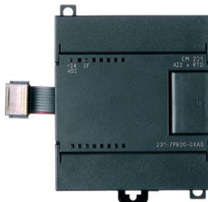
Slika 4.6. EM 231 – Analogni modul za proširivanje [18]
