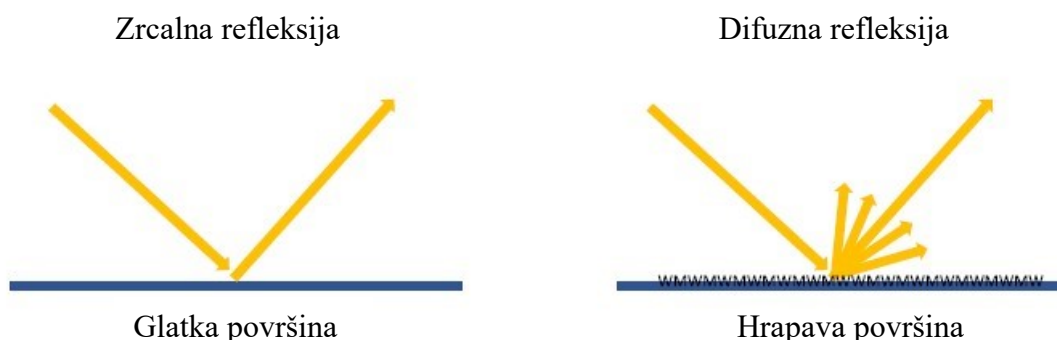
Slika 26. Shematski prikaz zrcalne i difuzne refleksije [36]
