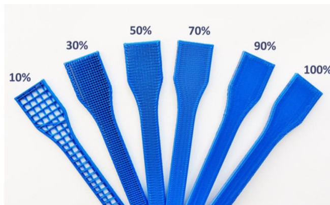
Slika 28. Prikaz različitih postotaka ispune poprečnog presjeka [13]
