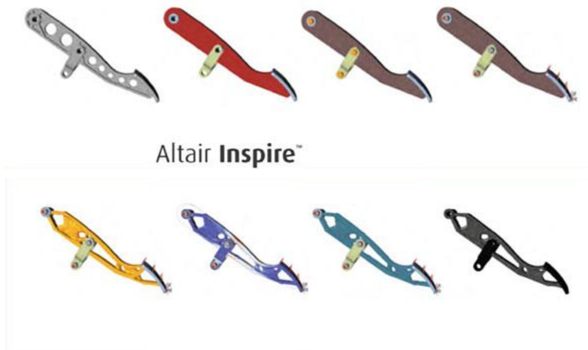
Slika 15. Primjer procesa topološkog optimiranja u programskom paketu Altair Inspire [1, 10]
