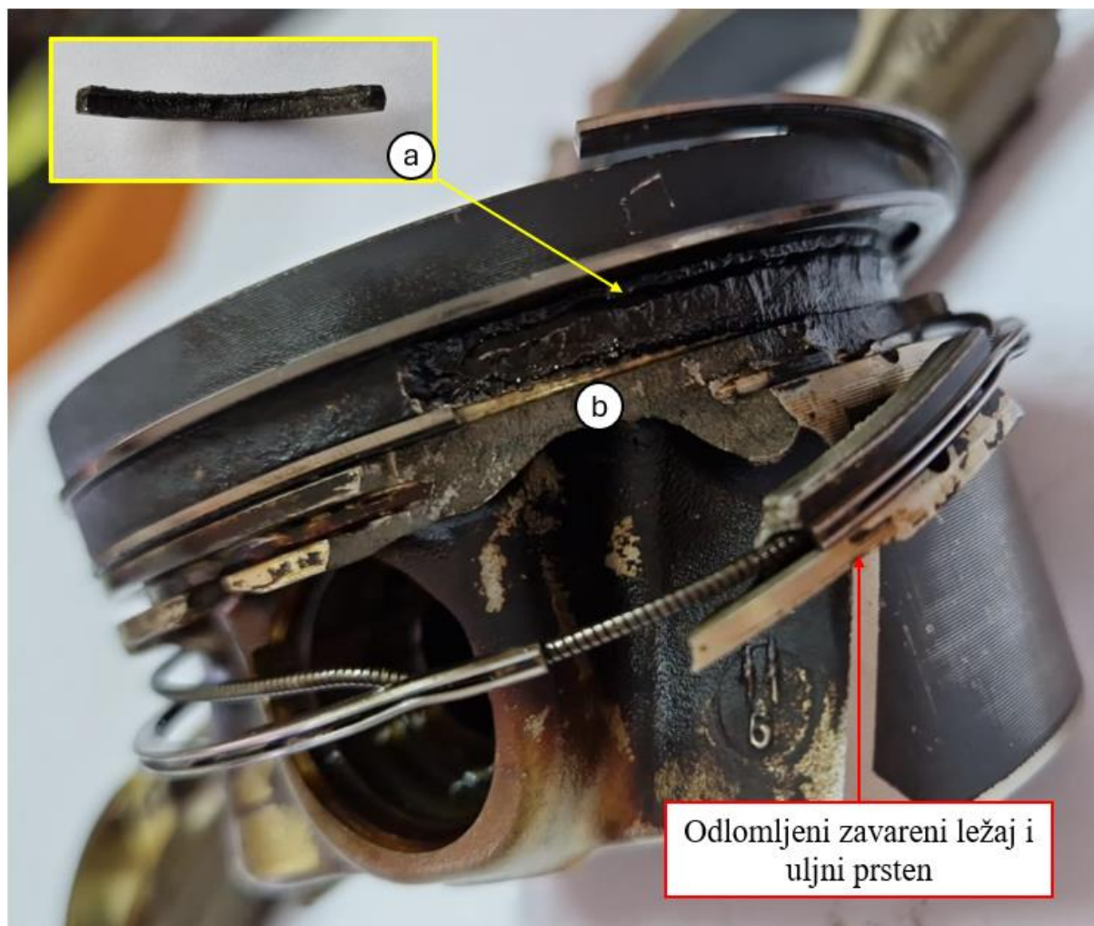
Slika 17. Neodmašćeni oštećeni klip, prednja perspektiva
