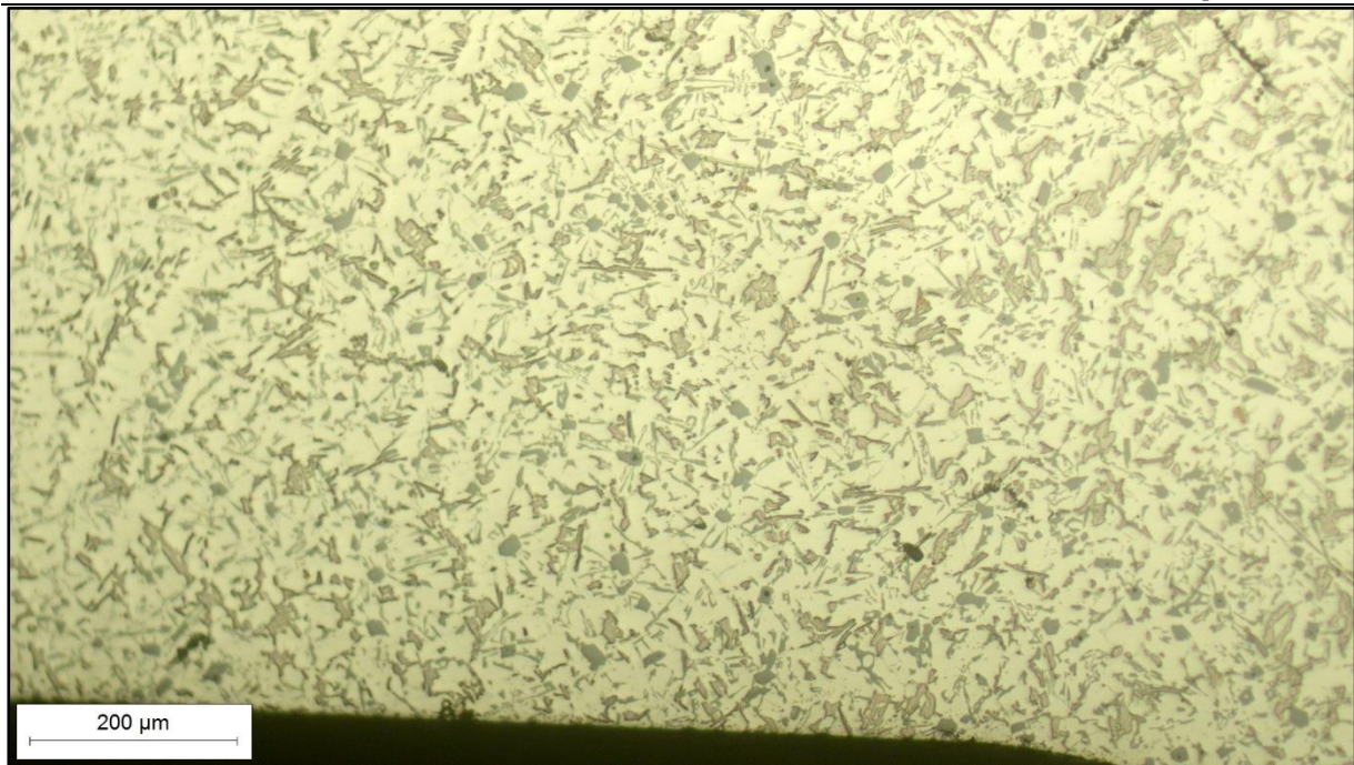
Slika 33. Neoštećena površina utora drugog kompresijskog prstena, uzorak A
