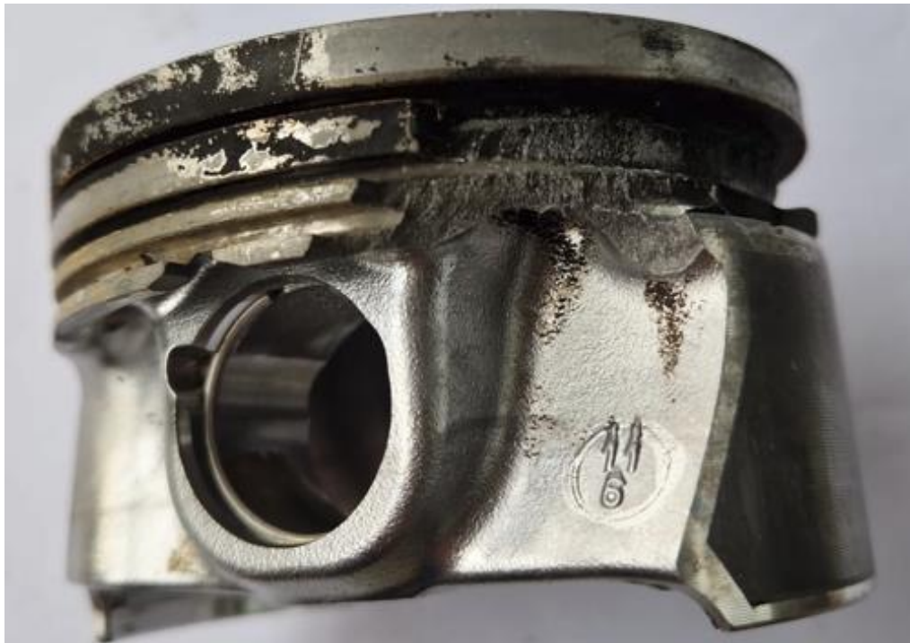
Slika 21. Prikaz loma na odmašćenom klipu s odlomljenim dijelovima klipa
