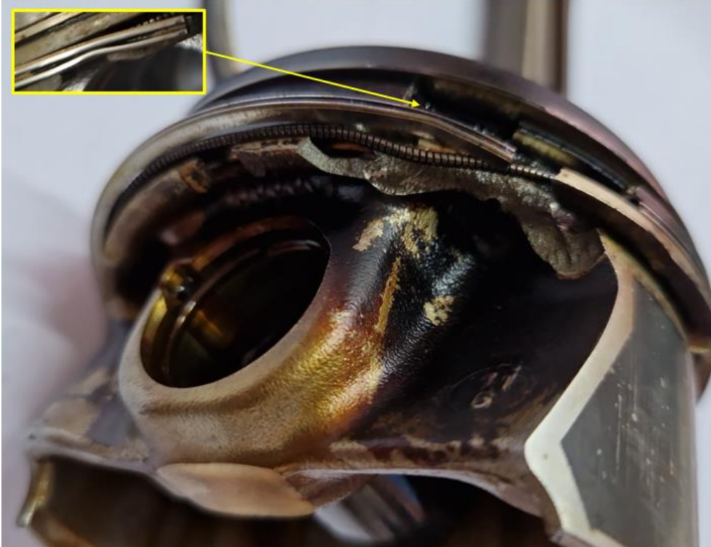
Slika 18. Neodmašćeni oštećeni klip, donja perspektiva
