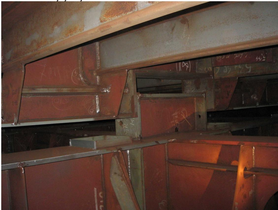
Slika 37 Ojačanje strukture dna bloka spremnika oko protuljuljnog ključa
